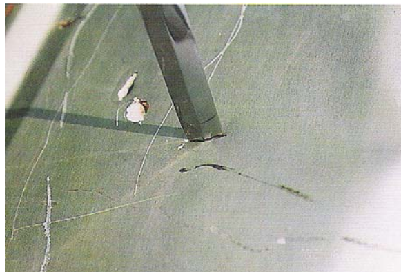
Abb. 5: Stichteste mit dem Wenshan-Schwert an einer Autotür
